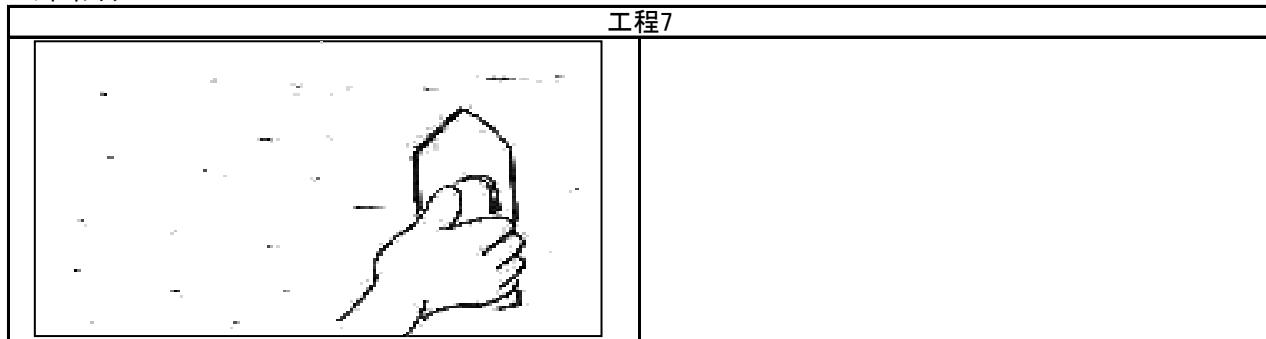
左官用ステンレスゴテ(角ゴテ)を用いてできるだけ平滑になるように模様付けをしてください。
